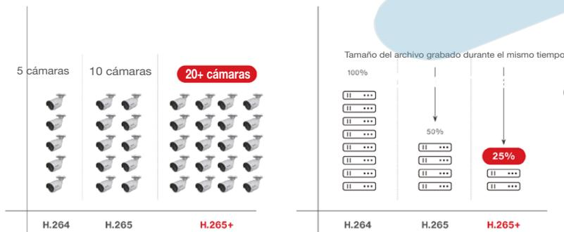
Capacidad de la cámara utilizando diferentes tecnologías de códec (bajo condiciones de red de 20 Mbps)
